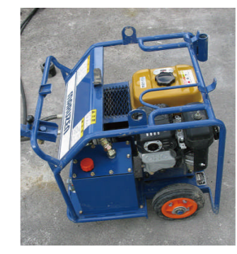
油圧パワーユニット
