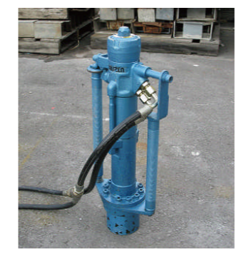
油圧杭打ち機
